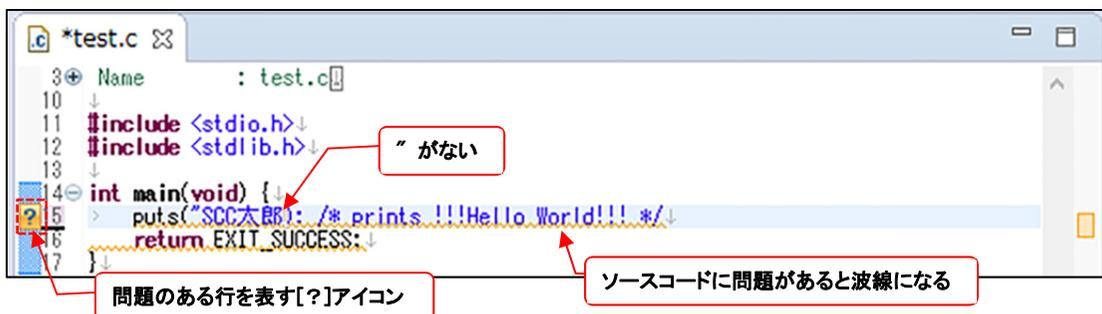
エラーの表示は、アイコンとソースコード上の波線で表現され、マウスカーソルを上に乗せると「ヒント」がポップアップして表示されます。
