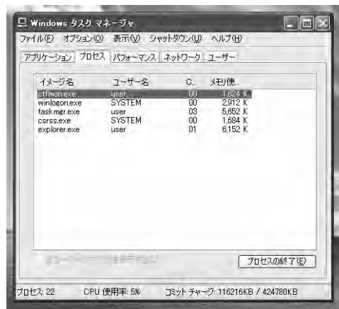
図1.8 WindowsXPのプロセスの表示例
