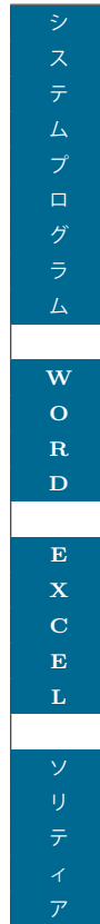
図 1.10: 実行中のプログラムが主記憶装置に格納されている様子
